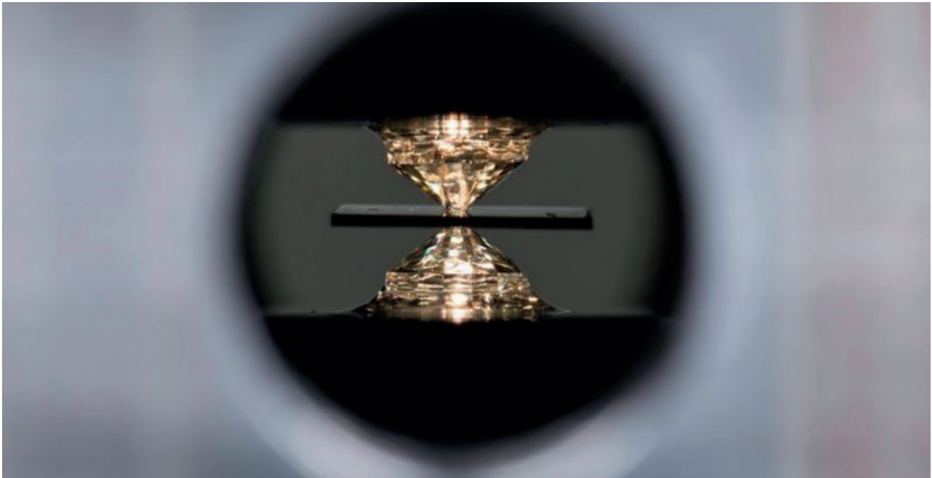
Un dispositivo de alta presión llamado celda de yunque de diamante fue usado para el experimento.
